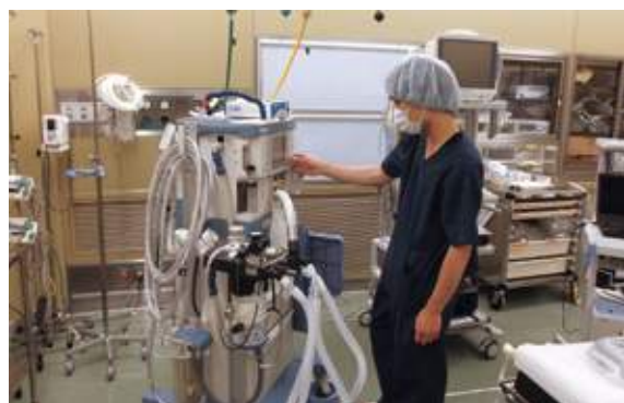
▲麻酔器の定期点検をしている様子
